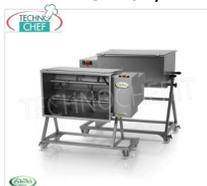
**FAMA - Mélangeur à viande en acier inoxydable avec chariot, 2 pales, capacité 120 Kg, Monophasé, V.230/1, mod.FIC100B/M**
