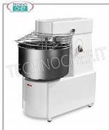
**MÉLANGEUR À SPIRALE 43 Kg avec bol de 48 litres, MONOPHASÉ, V.230/1**
